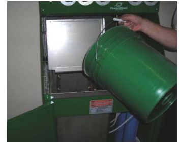
Or Pour Clean liquid back into the system
