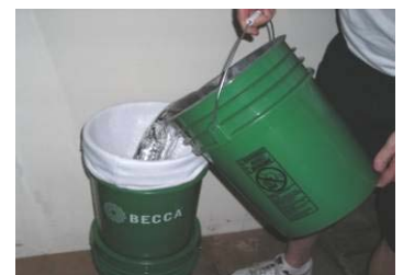
Pour Clarifier Container thru the Filter
